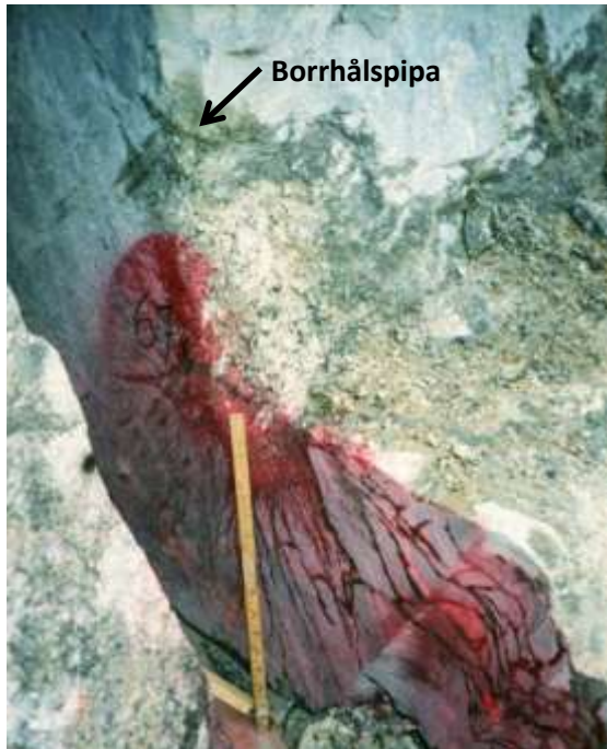
Figur 43. Skadezon från bottenladdning
