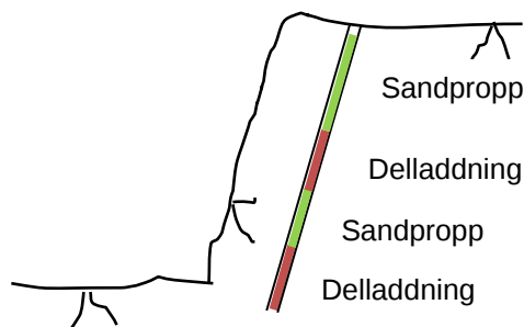
Figur 51. Uppdelning i delladdningar
