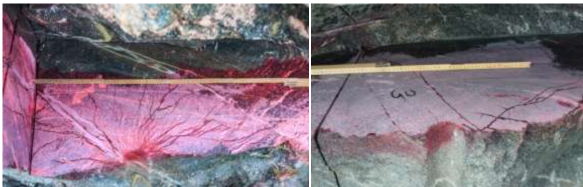
Figur 45. Sprickutbredning från detonerande stubin och Dynotex
