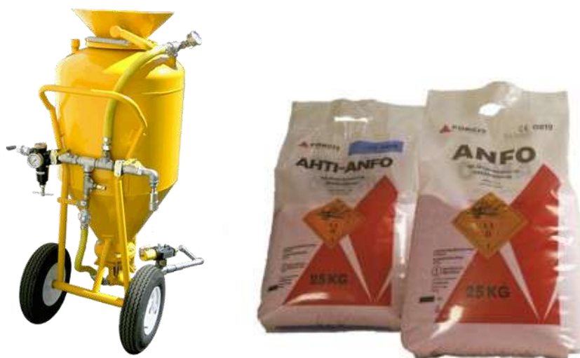
Figur 15. Exempel på laddutrustning för ANFO och säckar med ANFO.
