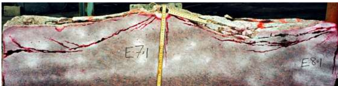
Figur 38. Sprickutbredning vid stort hålavstånd
