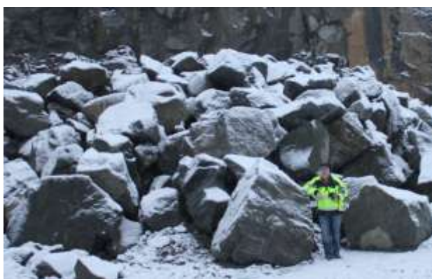
Figur 60. Exempel på skut från sprängning
