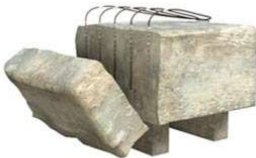
Figur 59. Hydraulisk spräckning (Foto Emstone)
