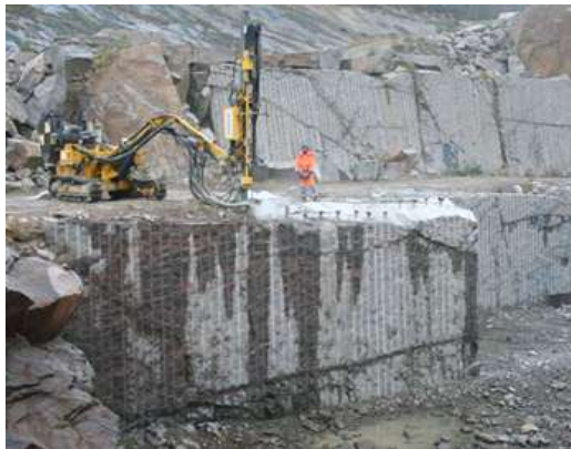
Figur 34. Bra borrhkvalitet och skonsam sprängning
