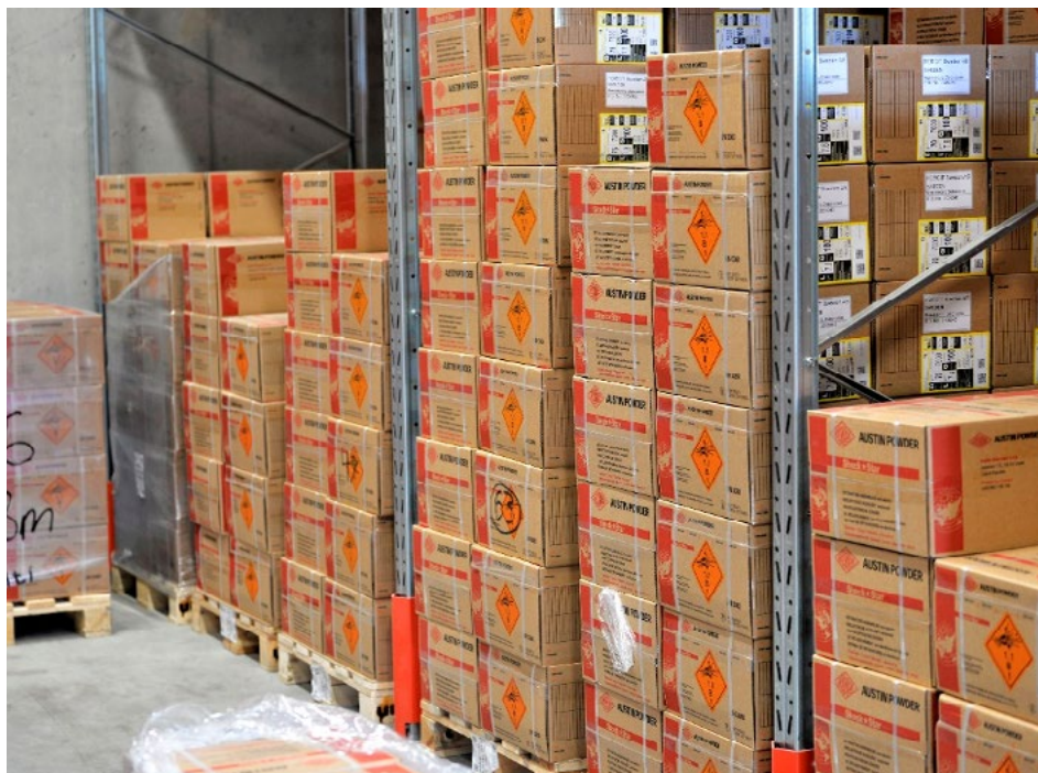
Bild 26: För att skydda de explosiva varorna bör de förvaras i sina transportförpackningar. Genom att låta kartongerna stå kvar på transportpallarna går det att få en luftspalt mellan varorna och förrådets golv.
