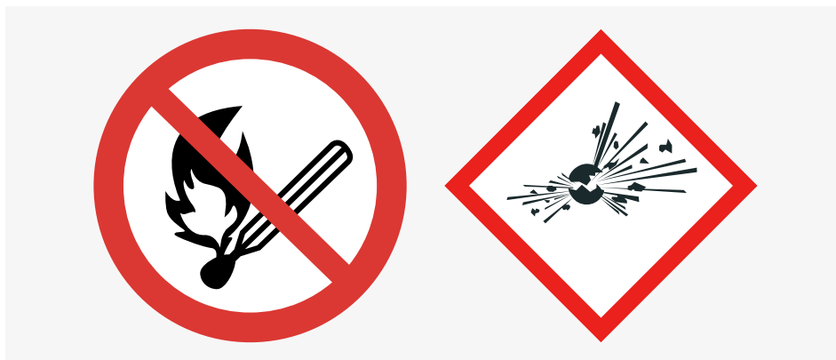
Bild 39: Förbuds- och varningsskylt till förråd för explosiva varor enligt bilaga 9 till MSBFS 2019:1. Till vänster: Förbud mot rökning och öppen eld. Till höger: Explosionsfara.
