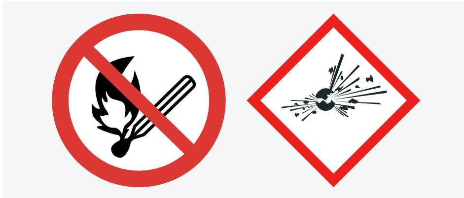
Bild 47: Förbuds- och varningsskylt som ska finnas vid byggnad eller lokal på tillverkningsplats där explosiva varor hanteras enligt 10 kap. 13 § MSBFS 2019:1 (från bilaga 9 till MSBFS 2019:1).
