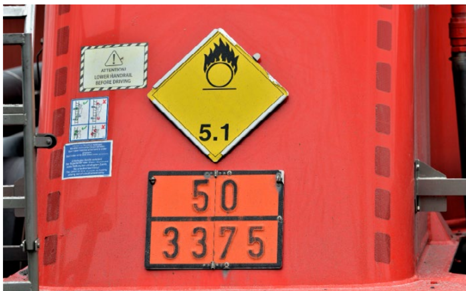
Bild 2: ANE som klassificerats för transport under UN-nr 3375 är inte en explosiv vara.
