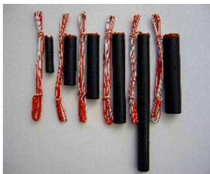
Bild 32: Exempel på explosiva varor i begärlighetsgrad B (ammunition, krut, stenspräckarpatroner med tändare och pyrotekniska tändare (eltändpärlor)).
